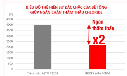
Kiểm nghiệm tại trung tâm VIBM theo tiêu chuẩn ASTM C1202
